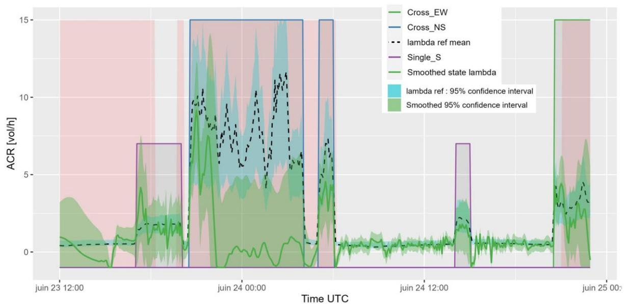
Figure 5.6 : Comparaison des estimations de ACR entre calculs STD ( $\lambda$  ref) avec intervalle de confiance fourni par l'analyse d'incertitude (section 3.3) et reconstructions par le modèle d'état M3 (Smoothed). Les zones colorées en rose représentent les instants pour lesquels  $\Delta CO_2 < 200$  ppm.
