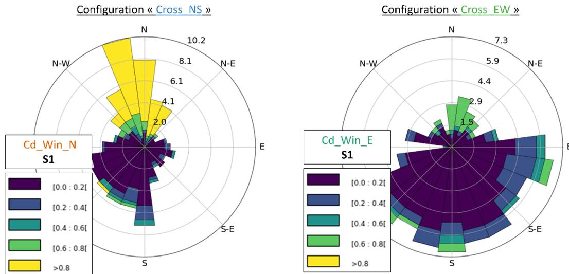
Figure 3.15 : Indices de Sobol en fonction de la direction du vent. Gauche : indice de Sobol de  $Cd_{Win_N}$  en configuration « Cross\_NS ». Droite : indice de Sobol  $Cd_{Win_E}$  en configuration « Cross\_EW ».
