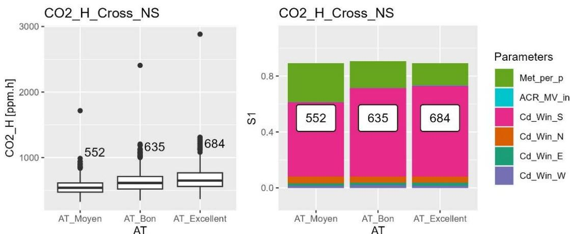
Figure Annexe L.4 : Sensibilité de l'indicateur CO<sub>2</sub>\_H\_Cross\_NS par rapport à l'incertitude des paramètres continus et paramètres catégoriels. Gauche : distribution sur les 1000 échantillons. Droite : moyenne et indices de Sobol associés à chaque paramètre.
