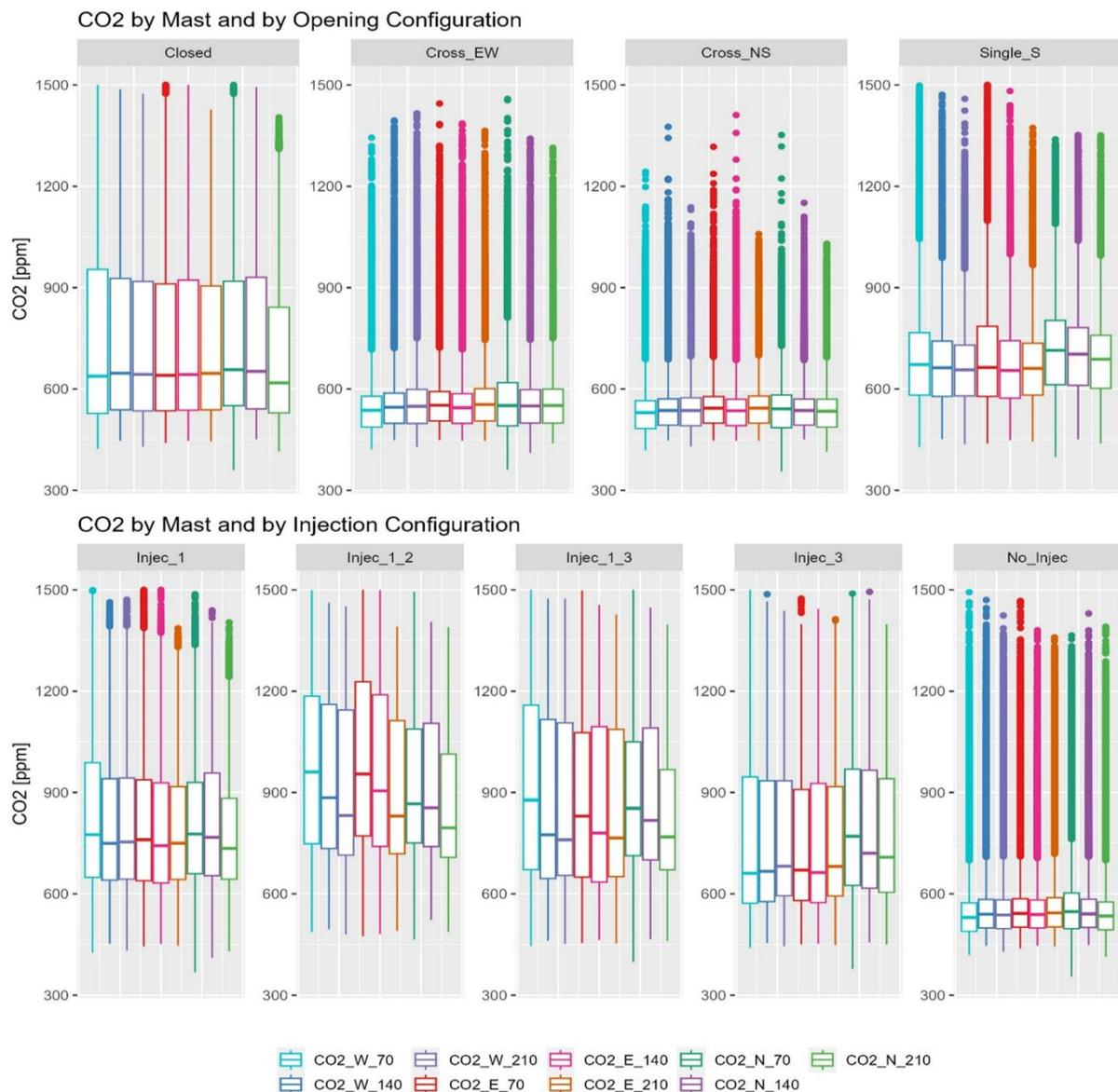
Figure 2.21 : Distributions du CO<sub>2</sub> à différentes positions et hauteurs. En haut : séparées par configurations d'ouvrants. En bas : séparées par positions d'injection.
