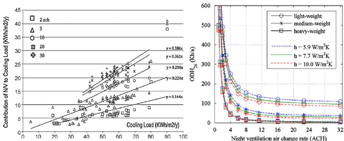
Figure 1.9 : Gauche : contribution de la ventilation naturelle au besoin de rafraîchissement, en fonction de l'ACR (2, 5, 10, 20 et 30  $\text{h}^{-1}$ ) (Santamouris et al., 2010). Droite : Degrés-heures d'inconfort pour différents ACRs (Artmann et al., 2008).
