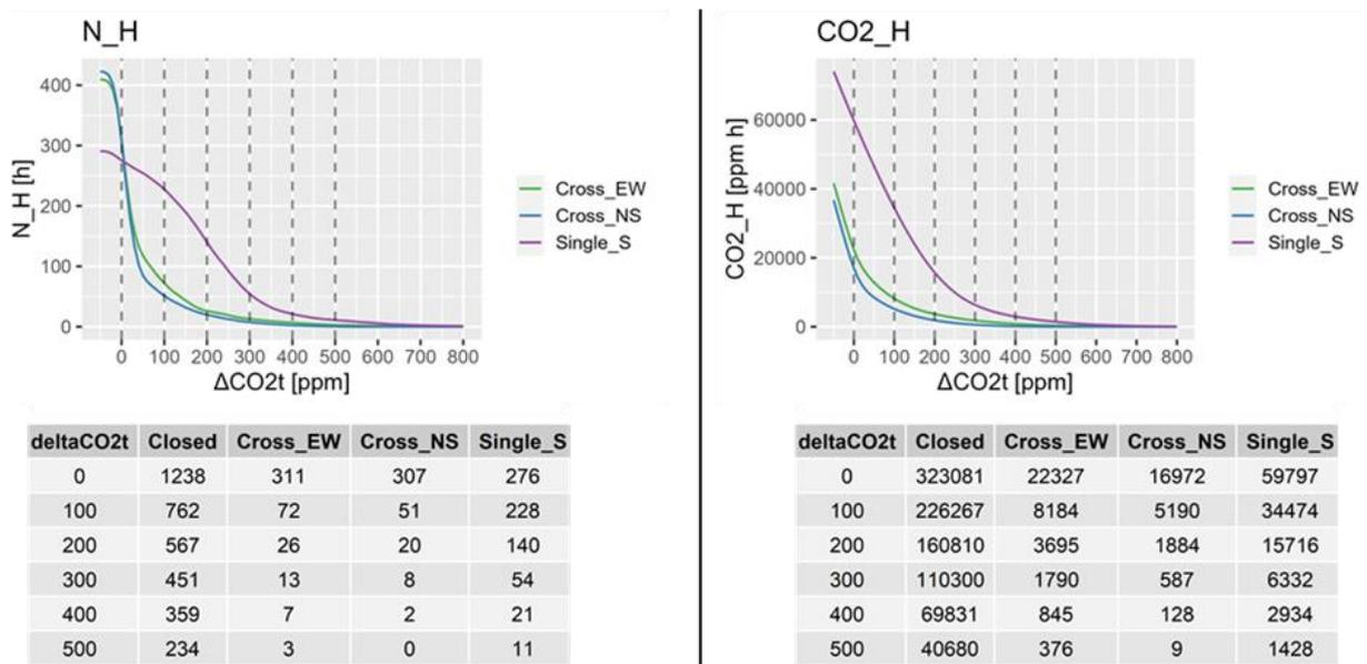
Figure 2.25 : Valeurs des indicateurs  $N_H$  et  $CO_2_H$ , pour chaque configuration d'ouvrants, et pour différentes valeurs seuils de  $\Delta CO_{2t}$ . Remarque : les valeurs négatives pour  $\Delta CO_2$  proviennent du bruit de la mesure de  $CO_2_{Ext}$ .
