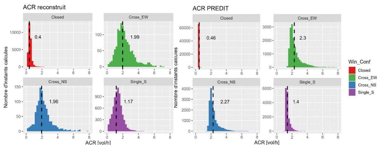
Figure 5.14 : Gauche : Distribution des ACRs reconstruits avec le modèle statistique M3 appliqué aux données expérimentales. Seuls les instants pour lesquels  $\Delta CO_2 > 200$  ppm sont considérés. Droite : Distribution des ACRs prédits avec le modèle de régression linéaire, sur toute la base de données expérimentale. Les moyennes géométriques sont affichées et tracées en pointillés verticaux.
