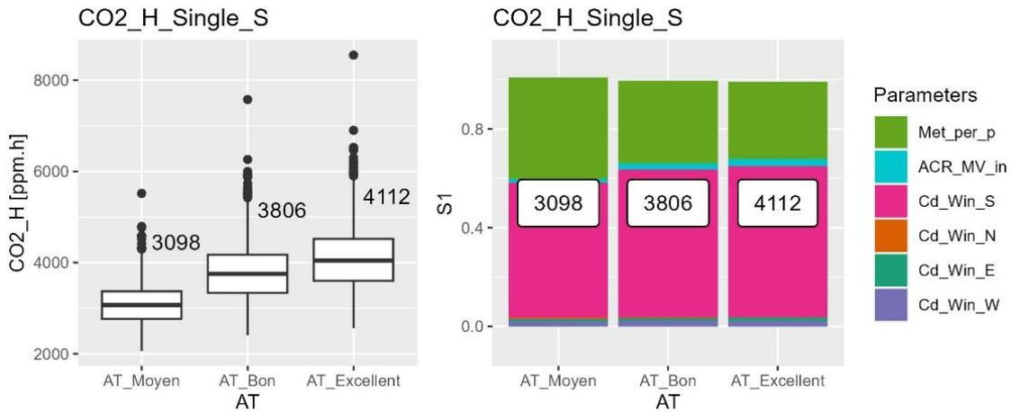
Figure Annexe L.5 : Sensibilité de l'indicateur  $CO2\_Single\_S$  par rapport à l'incertitude des paramètres continus et paramètres catégoriels. Gauche : distribution sur les 1000 échantillons. Droite : moyenne et indices de Sobol' associés à chaque paramètre.
