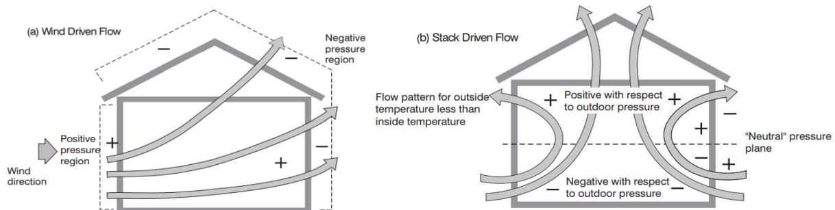
Figure 1.4 : Ventilation naturelle par effets de vent (gauche) et de température (droite) (Liddament, 1996).
