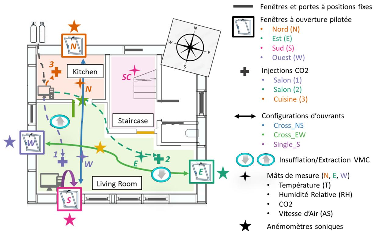
Figure 2.8 : Schéma du volume expérimental. Représentation des différentes configurations d'ouvrants, des positions d'injection de CO<sub>2</sub> et des bouches de VMC. Instrumentation : mâts comprenant les capteurs de température, humidité relative, concentration de CO<sub>2</sub>, anémomètres thermiques ; anémomètres soniques.
