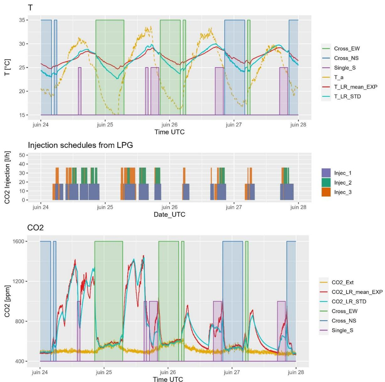
Figure 3.9 : Comparaison entre sorties STD et mesures expérimentales moyennées sur la zone [salon]. Quatre jours types.  $T_a$  et  $\text{CO}_2_{Ext}$  sont les températures et concentration de  $\text{CO}_2$  extérieurs.
