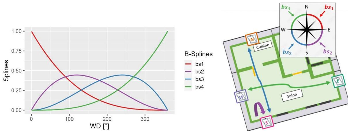
Figure 5.10 : Gauche : génération d'une base de quatre B-splines  $bs_i(WD)$ , sur la plage de variation de  $WD$   $[0-360]^\circ$ . Droite : régions d'influence des B-splines en fonction de la direction du vent et correspondance avec l'orientation du bâtiment I-OB.
