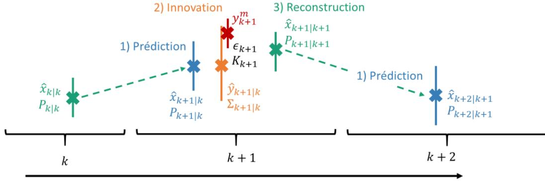
Figure 4.2 : Schéma de principe du filtre de Kalman, entre les instants  $k$  et  $k+1$ , adapté de (Rouchier et al., 2019).  $\hat{x}$  sont les valeurs moyennes et  $P$  la covariance des états.  $\hat{y}$  sont les valeurs moyennes et  $\Sigma$  la covariance des sorties.  $y$  est la mesure.  $\epsilon$  est l'erreur de prédiction à horizon un pas de temps et  $K$  est le gain de Kalman.
