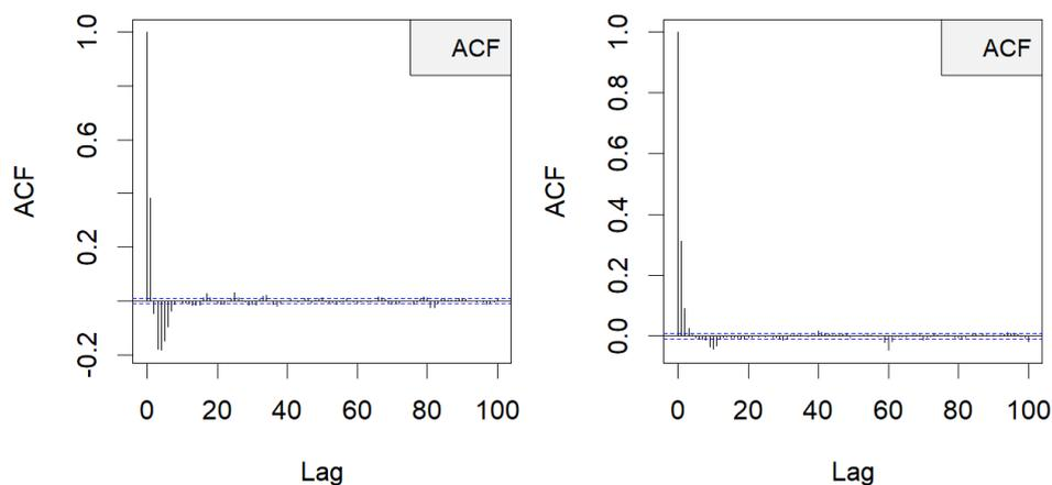
Figure 5.2 : Fonction d'autocorrélation (ACF) des résidus du modèle M3 ( $\text{Co}_2\text{LambdaKProd}$ ) à partir des données mesurées expérimentalement. Gauche :  $\epsilon_{\text{CO}_2}$ . Droite :  $\epsilon_{\text{Prod}}$ .
