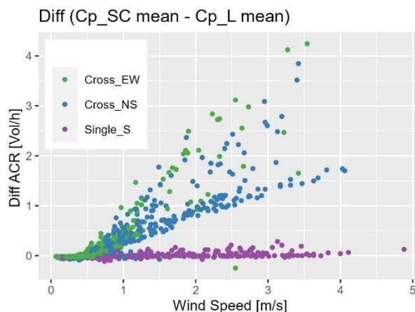
Figure 3.18 : Variabilité de l'ACR\_Total entre les versions de calcul ( $Cp_{SC}$ ) et ( $Cp_L$ ). Différence entre valeurs moyennes, en fonction de la vitesse du vent, et de la configuration d'ouvrants.
