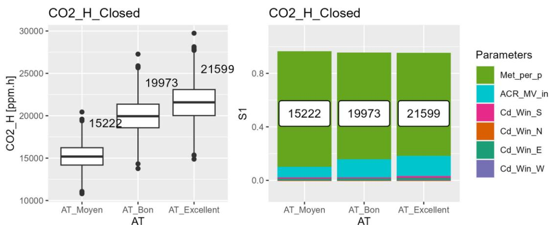
Figure 3.22 : Sensibilité de l'indicateur  $CO_2_H_{Closed}$  par rapport à l'incertitude des paramètres continus et paramètres catégoriels. Gauche : distribution sur les 1000 échantillons. Droite : moyenne et indices de Sobol associés à chaque paramètre.
