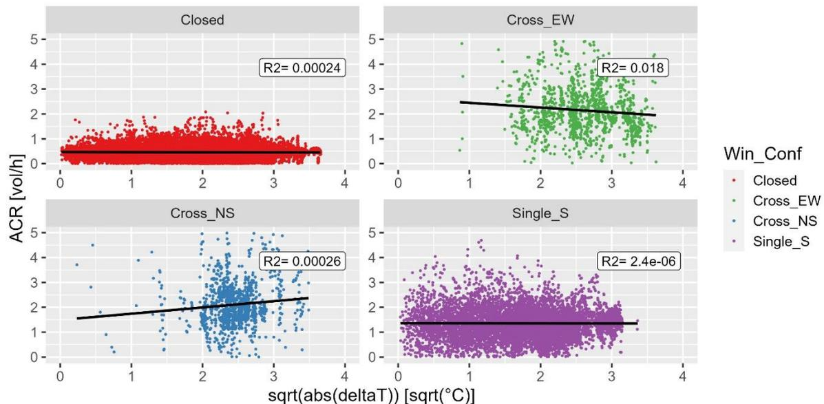
Figure 5.8 : ACRs estimés avec le modèle statistique M3 en fonction de l'écart de température  $\sqrt{|\Delta T|}$ , pour chaque configuration d'ouvrants. Seuls les instants pour lesquels  $\Delta CO_2 > 200$  ppm sont considérés. Le nuage de points et la régression linéaire avec coefficient de corrélation  $R^2$  sont affichés.
