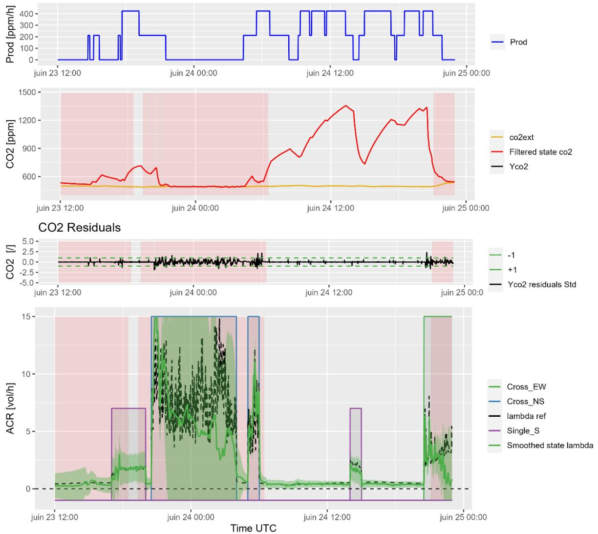
Figure 4.6 : Séries temporelles reconstruites à partir du modèle d'état M2 ( $co2\lambda K$ ), alimenté par les données STD. Entrées ( $Prod$  et  $co2ext$ ), état mesuré ( $Y_{co2}$ ), résidus ( $Y_{co2}$  residuals Std), état  $co2$  filtré (Filtered state  $co2$ ), état  $\lambda$  lissé (Smoothed state  $\lambda$ ), ACR de référence ( $\lambda_{ref}$ ). Les zones colorées en rose représentent les instants pour lesquels  $\Delta CO_2 < 200$  ppm.
