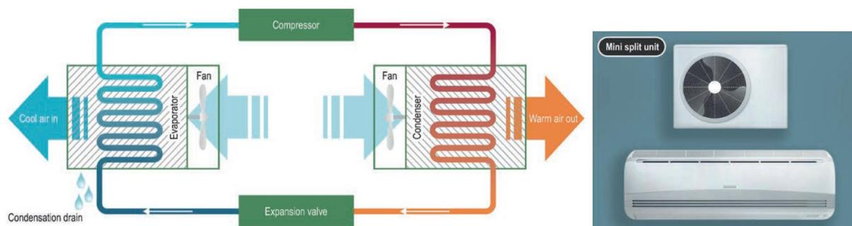
Figure 1.2 : Gauche : cycle thermodynamique d'un climatiseur. Droite : illustration d'un split (droite).
