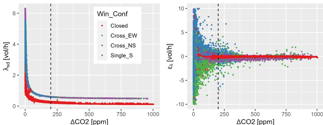
Figure 4.12 : Modèle M3 : corrélations entre l'écart  $\Delta CO_2$  et écarts type de prédiction de l'ACR  $\lambda_{sd}$  (gauche) ; erreur  $\epsilon_\lambda$  (droite). Pour les différentes configurations. Traits pointillés : seuil  $\Delta CO_2_t = 200$  ppm.
