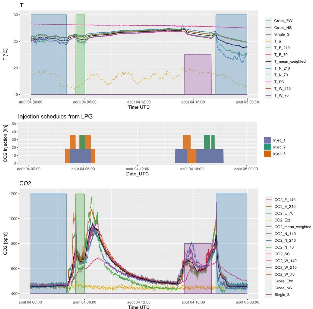
Figure 2.20 : Mesures des températures, injections de CO<sub>2</sub>, et mesure des concentrations en CO<sub>2</sub>, en fonction des ouvertures de fenêtres. Illustration sur une journée type (04/08/2023).
