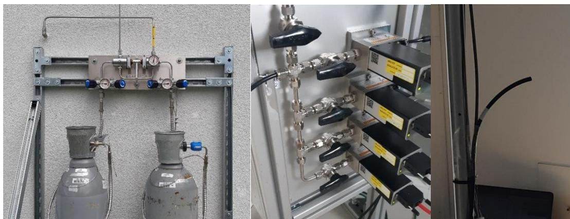
Figure 2.10 : Bouteilles de CO<sub>2</sub>, vannes et débitmètre d'injection, et extrémité du tuyau d'injection.
