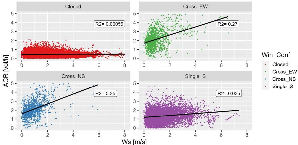
Figure 5.9 : ACRs estimés avec le modèle statistique M3 en fonction du vent météo (Ws), pour chaque configuration d'ouvrants. Seuls les instants pour lesquels  $\Delta\text{CO}_2 > 200$  ppm sont considérés. Le nuage de points et la régression linéaire avec coefficient de corrélation  $R^2$  sont affichés.
