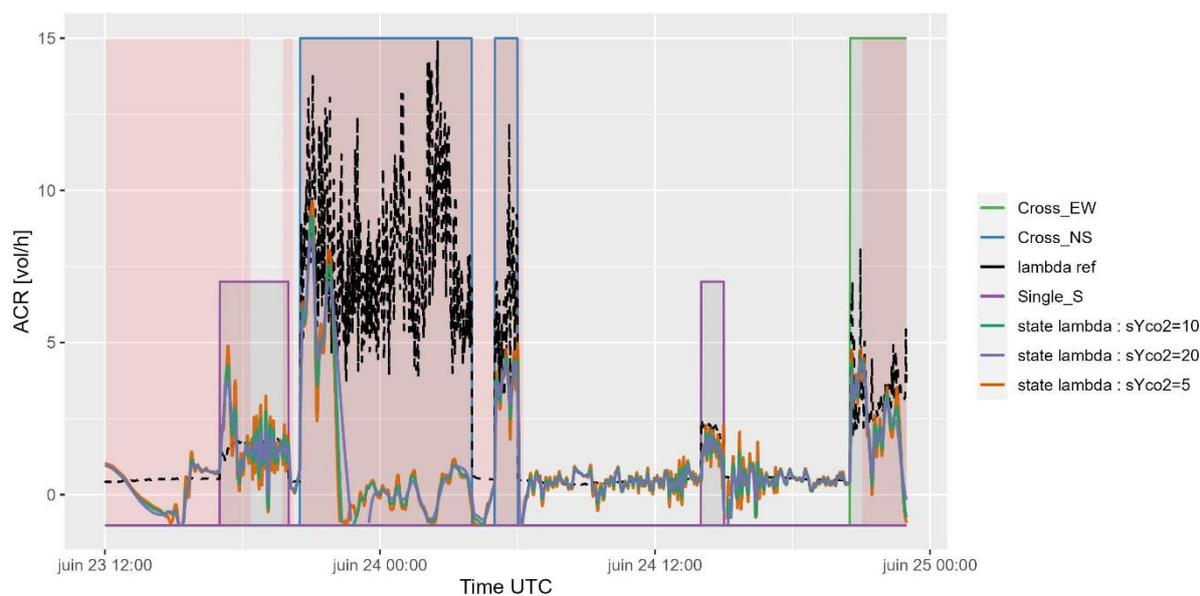
Figure Annexe Q.1 : Séries temporelles reconstruites à partir du modèle M3, alimenté par les données expérimentales. Comparaison de l'état  $\lambda$  lissé (Smoothed state lambda) pour différentes valeurs de paramètres  $sY_{CO_2}$  (5, 10 et 20 ppm). La courbe en ACR pointillés correspond à la valeur de référence calculée par STD. Les zones colorées en rose représentent les instants pour lesquels  $\Delta CO_2 < 200$  ppm.
