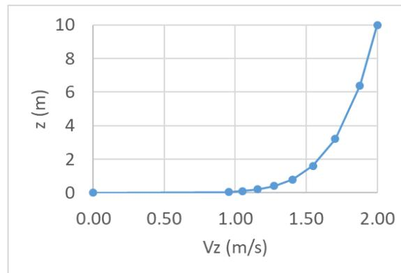
Figure 3.3 : Profil logarithmique de vent tenant compte de la couche limite pour un vent mesuré à 2 m/s à une hauteur de 10 m. Avec les paramètres  $\alpha = \alpha_{met} = 0,14$  et  $\delta = \delta_{met} = 270$  m.
