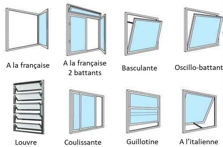
Figure 1.6 : Différents types d'ouvertures de fenêtres.
