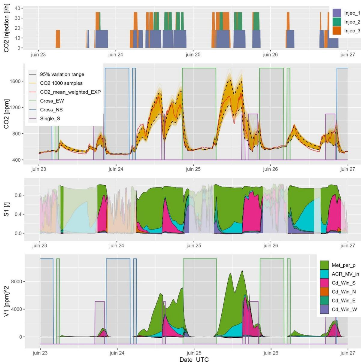
Figure 3.20 : Profil de vent, distributions des CO<sub>2</sub>, indices de Sobol et variances partielles sur la période 23/06/2023 – 27/06/2023. Pour plus de lisibilité, l'intervalle de variabilité à 95 % en CO<sub>2</sub> est lissé avec une moyenne glissante centrée autour d'une fenêtre de 25 min. Les zones grisées pour S1 correspondent aux zones pour lesquelles la variabilité est inférieure à  $12,5^2 \text{ ppm}^2$ .
