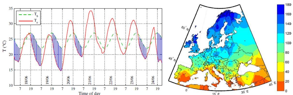
Figure 1.8 : Gauche : illustration du calcul du CCP.  $T_b$  est la température de confort à maintenir.  $T_e$  est la température extérieure. Les zones hachurées représentent le CCP. Droite : CCP calculés sur le mois de Juillet 2003 en Europe. Repris de (Artmann et al., 2007).
