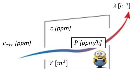
Figure 1.14 : Illustration du bilan du gaz traceur équation (1.13), dans le cas in situ. Le terme  $P$  correspond au CO<sub>2</sub> métabolique produit par à l'occupant.
