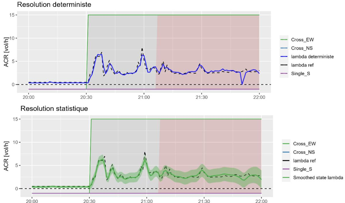
Figure 4.11 : Comparaison des estimations de ACR entre résolution instantanée déterministe M0 (haut) et résolution par modèle statistique M3 (bas) à partir des données générées numériquement en STD. Les zones colorées en rose représentent les instants pour lesquels  $\Delta CO_2 < 200$  ppm.
