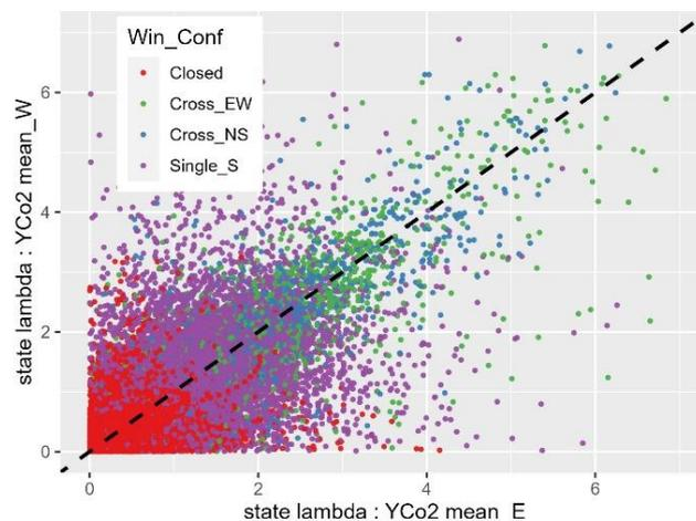
Figure 5.4 : Corrélations des estimations lissées de  $\lambda$  avec le modèle M3, en fonction du choix de la valeur de référence pour Yco2 (moyennes aux mâts E ou W). Seules les estimations pour lesquelles  $\Delta CO_2 > 200ppm$  sont affichées. Par configuration d'ouvrants. La droite en pointillés ( $Y=X$ ) symbolise la ligne idéale de résultats égaux pour les deux calculs.
