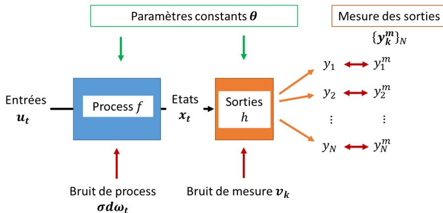
Figure 4.1 : Schéma de principe du modèle d'état. Les bruits de process et de mesures sont les termes stochastiques.
