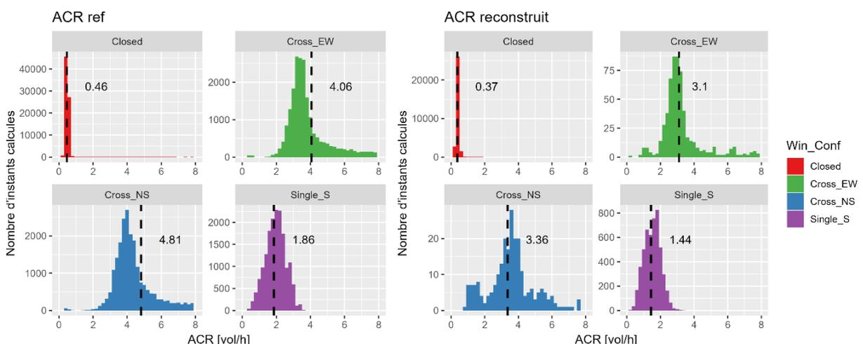
Figure 4.13 : Distribution des ACRs de référence STD (gauche) et ACRs reconstruits pour les instants vérifiant  $\Delta\text{CO}_2 < 200$  ppm (droite), sur la base de données numérique générée par STD. Par configuration d'ouvrants. La valeur en pointillée est la moyenne géométrique de la distribution.
