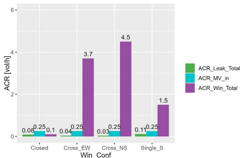
Figure 3.8 : Valeurs moyennes géométriques des ACRs, pour chaque configuration d'ouvrant. A travers les infiltrations (ACR\_Leak\_Total). A travers les fenêtres (ACR\_Win\_Total). Ventilation mécanique (ACR\_MV\_in).
