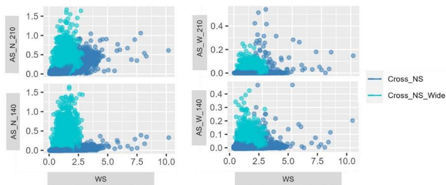
Figure Annexe E.1 : Corrélations entre vitesses d'air météo et vitesses d'air intérieures pour la configuration traversante (N/S) en oscillo-battant et en grande ouverture (Wide).
