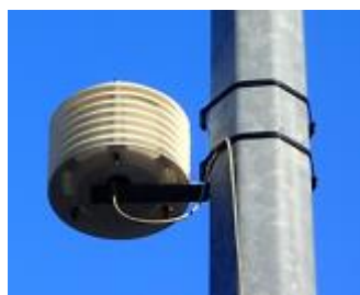
Figure 5 : Abri Stevenson contenant un capteur Tinytag.
