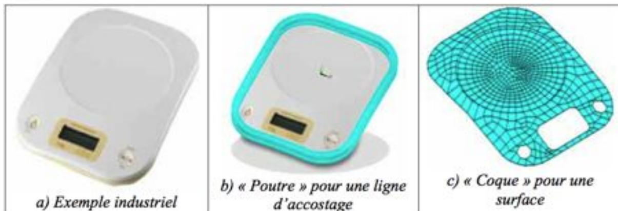
Figure 2.3.1 Modèle « poutre » ou modèle « coque »
