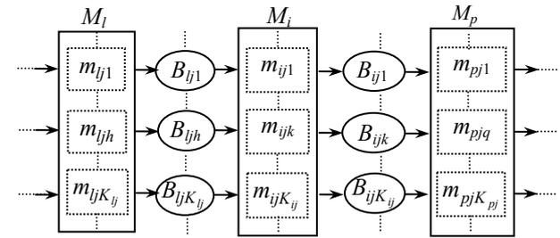
Figure 1. Décomposition d'une machine multi-produit en sous-machines mono-produit.
